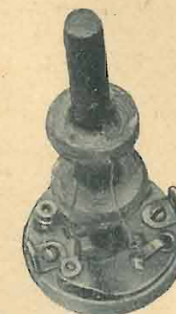
Trasformatore di media frequenza fotografato aperto.
